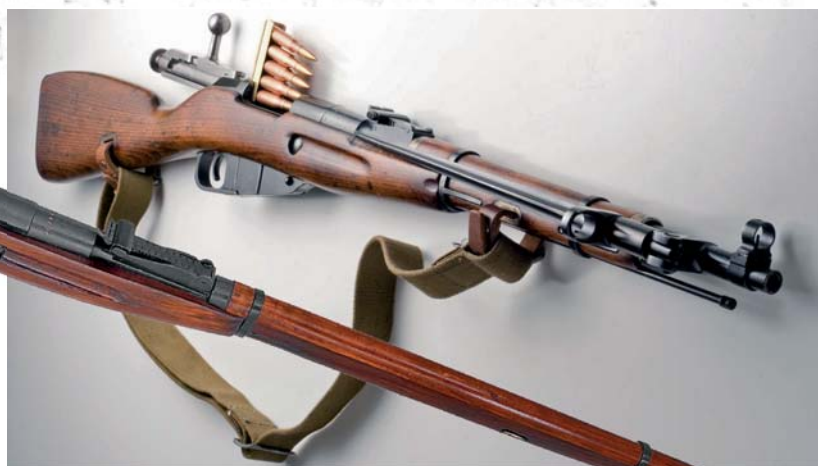
Karabinek wz.1944 – wyraźnie widoczny zamek otwarty do załadowania magazynka z tódkki i bagnet szpadowy złożony do położenia marszowego FOT. WALL.ALPHACODERS.COM
