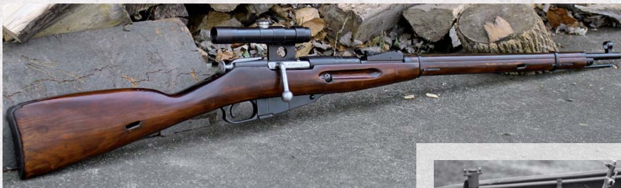
Snajperska triochliniejka z celownikiem optycznym PU o powiększeniu trzykrotnym FOT. REDDIT.COM
