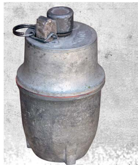
Karbidówka – ciężki granat obronny o skorupie wykonanej z korpusu lampy karbidowej i z przerobionym zapalnikiem wz. Gr.31 pozbawionym tyłki FOT. LESZEK ERENFEICHT ZE ZBIORÓW MNiP
