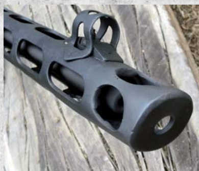
Ukształtowane w osłonie lufy wielofunkcyjne urządzenie wylotowe łączące cechy kompensatora odrzutu i hamulca odrzutu FOT. ARCHIWUM
