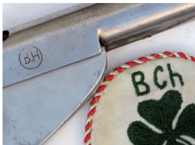
Bechowce oznaczane były na zamkach cechą „S.H. W. 44” (Strąpoc Henryk wzór 1944) i symbolem „BH” – przy czym błąd ortograficzny nie wynikał z niewiedzy konstruktora, tylko ze zdekompletowania zestawu wybijaków literowych dostępnych w kuźni
